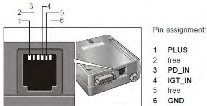
Abbildung B.1.: Belegung der Netzteilbuchse
